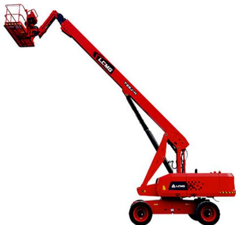
LGMG dispone de una línea completa de plataformas de trabajo aéreas de brazos telescópicos motorizados y de gran capacidad, con una altura máxima de trabajo que oscila entre 21,8 y 29,8 metros y con un diseño de doble capacidad de 450/300 kg (992/661 lb). La máquina puede permitir que hasta 3 personas trabajen al mismo tiempo tanto en interiores como en exteriores, lo que mejora enormemente la eficiencia del trabajo.
